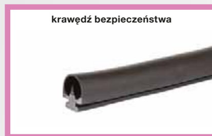
krawędź bezpieczeństwa SC.RES 150zł / SC.RL 420zł 9270060 / 9270061 Krawędź bezpieczeństwa z gumy przewodzącej. Szerokość 28,5 mm Opakowanie 20m. SC.RES: wysokość 25 mm. SC.RL: wysokość 65 mm.
